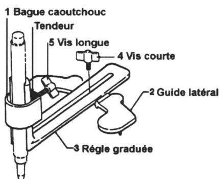
Assembler le guide latéral et la règle graduée à l'aide de la vis courte
