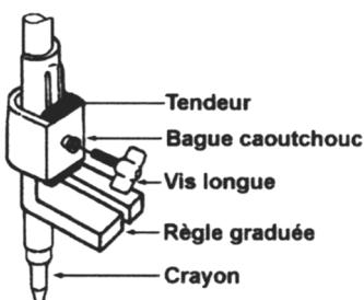
Passer un crayon dans la bague caoutchouc, serrer la vis longue.
